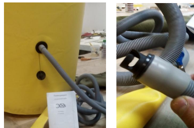
Рис.8. Подсоединение шланга с переходником к клапану Все
